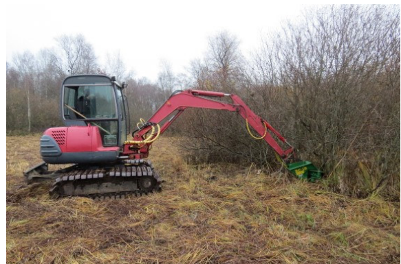
Abb. 21: Rationelle Rodung von Grauweiden mittels Greifzange auf Pflegeflächen im Naturschutzgebiet Federsee.
