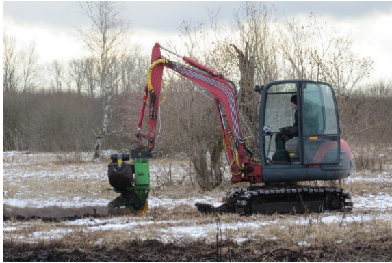
Abb. 22: Abfräsen der Stümpfe, um Flächen mähbar zu machen.
