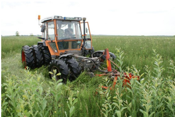
Abb. 20: Traktor mit 10facher Bereifung zur schonenden Pflege auch nassester Flächen.
